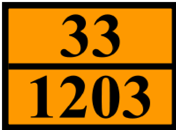
Przykładowa tablica ADR do oznaczenia transportu benzyny
